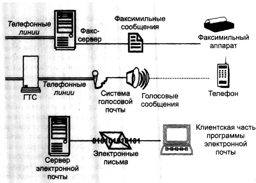
Рис. 8.10. Схема раздельной обработки сообщений
