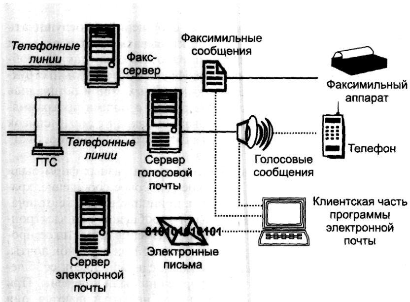
Рис. 8.11. Единый интерфейс пользователя при раздельном хранении и обработке сообщений
