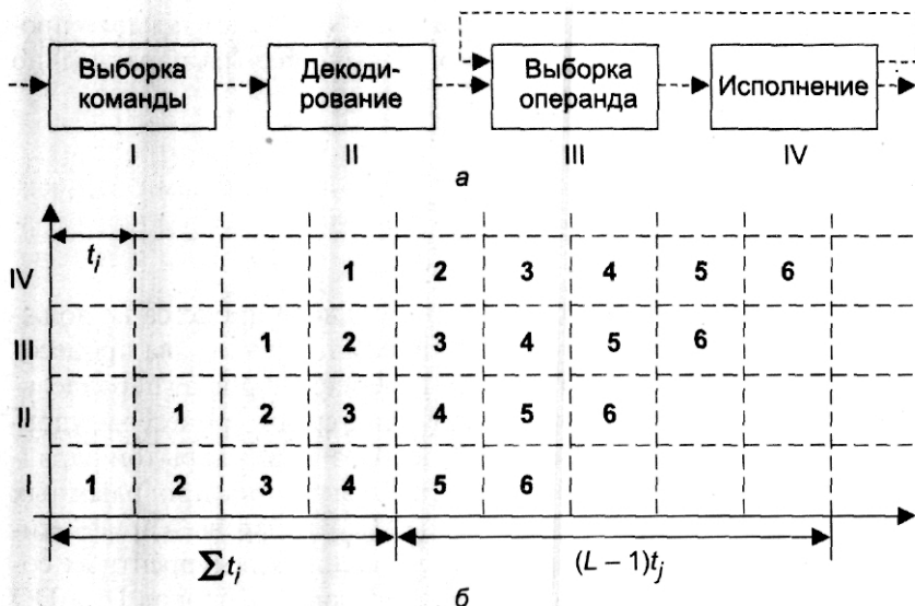
Рис. 4.9. Схема четырехступенного устройства обработки команд: a — ступени конвейера; б — временная диаграмма работы
