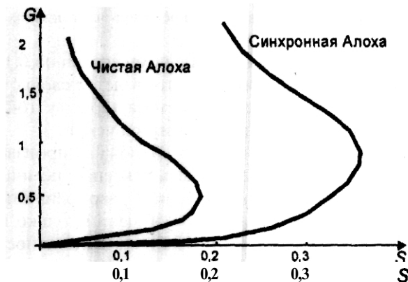
Рис. 6.21. Кривые производительности при чистой и синхронной Алохе
